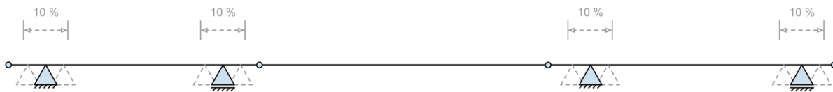
Abbildung: Konzeptionelles statisches System (Gerberträger) mit variabler Stützenposition
